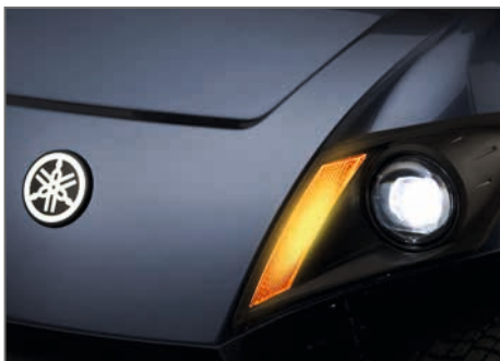
Bromsljussats (kompletterar grundstrålkastare med LED-bromsljus med 20 dioder) Del nr GCAJ0A1300PM
