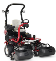
TORO GREENSMaster 3370 KLIPPBREDD ..... 150CM KLIPPHÖJD ..... 8,9MM-24MM KLIPPKAPACITET ... 1,3HA/TIM ELEKTRISK, MARKFÖLJANDE CYLINDERKLIPPDÄCK
