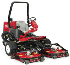
TORO REELMASTER 3500 SIDEWINDER KLIPPBREDD ..... 173CM KLIPPHÖJD ..... 19MM-102MM KONTURKLIPPDÄCK MED SIDOFÖRSKJUTNINGSSYSTEM
