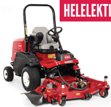
TORO GROUNDMASTER e3200 KLIPPBREDD ..... 152CM KLIPPHÖJD ..... 25MM-152MM KLIPPKAPACITET .. 3,1HA/TIM ELEKTRISK, TILTBAART FRONTKLIPPDÄCK
