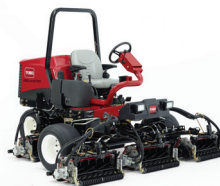
TORO REELMASTER 3555-D/3375-D KLIPPBREDD ..... 254CM FEM KLIPPAGGREGAT, LÄTTVIKTSKLIPPARE
