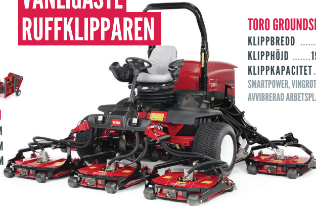
TORO GROUNDMASTER 1200 KLIPPBREDD ..... 365CM KLIPPHÖJD ..... 13MM-102MM KLIPPKAPACITET .. 3-3,65HA/TIM BOGSERAD ROTORKLIPPARE
