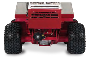
HJULBREDDARE Öka stabiliteten i sluttningar upp till 25°.
