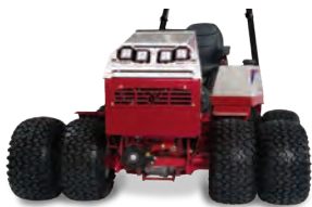
DUBBELMONTAGE Öka stabiliteten, dragkraften och säkerheten i sluttningar upp till 30°.
