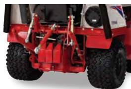
3-PUNKTSLYFT Lägg till icke-kraftuttagsdrivna redskap baktill med kategori 1 3-punktskoppling.
